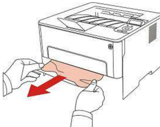
3. Nach dem Entfernen vom Papier legen Sie die Karton bitte wieder in den Drucker. Öffnen und schließen den Frontdeckel, dann kann der Drucker wieder drucken.
