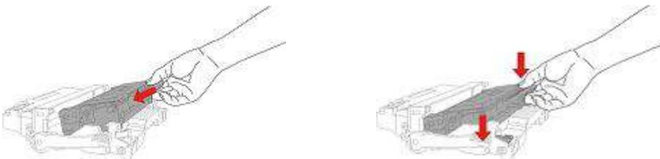
7. Entlang der Schiene des Druckers legen Sie den fertig installierten Trommelmodul im Drucker und erledigen Sie die Installation.
