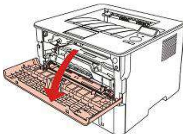
5. Entlang der Schiene nehmen Sie den Lasertoner aus. (Um zu vermeiden, dass die Qualität des Druckens wegen Belichtung der Lichttrommel verschlechtert wird, benutzen Sie bitte die Schutzhülle oder dicke Papier, um den Lasertoner zu verpacken.)
