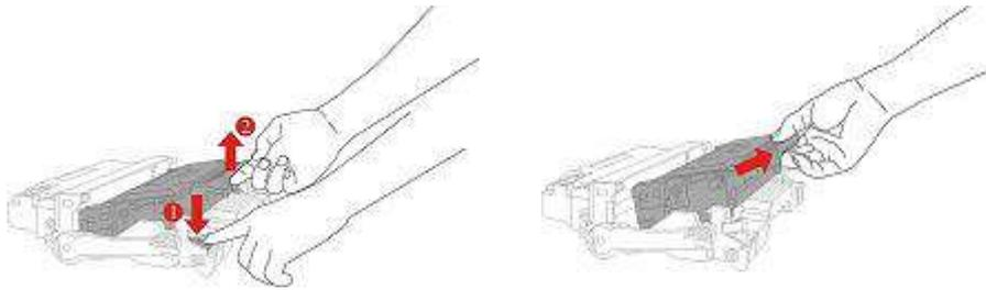
4. Öffnen Sie die Verpackung von dem neuen Toner und halten Sie die Griff des Toners. Schütteln Sie den Toner leicht fünf bis sechs Mal, damit der Puder darin gleichmäßig verteilt werden.
