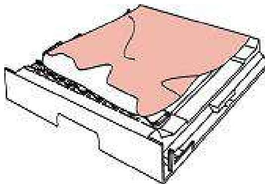
3. Öffnen Sie das Fach und entfernen Sie das gestaute Papier direkt von unten, falls das Papier nicht zusammen mit der Duplexdruck-Einheit aus dem Drucker kommt.
