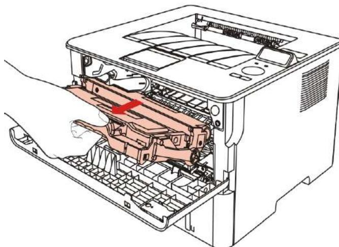
3. Drücken Sie mit der linken Hand den blauen Knopf links von dem Trommelmodul und ziehen Sie mit der rechten Hand die Griff des Toners gleichzeitig nach oben. Nehmen Sie den Toner aus.
