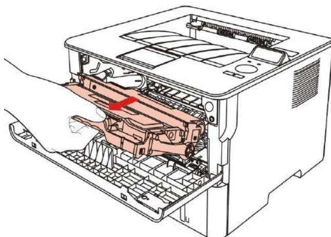
3. Drücken Sie mit der linken Hand den blauen Knopf links von dem Trommelmodul und ziehen Sie mit der rechten Hand die Griff des Toners gleichzeitig nach oben. Nehmen Sie den Toner aus.
