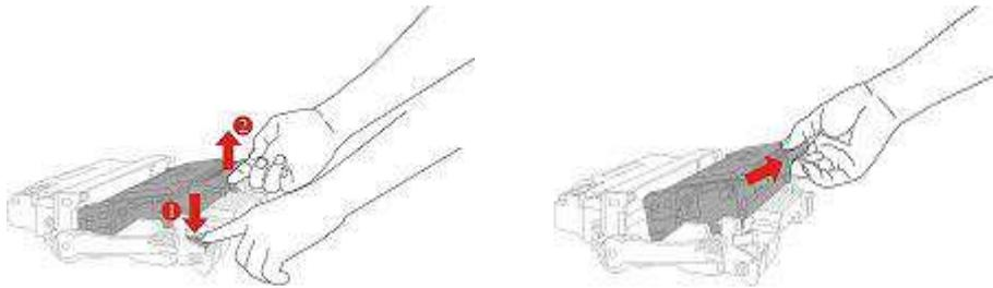
4. Öffnen Sie die Verpackung von dem neuen Toner, ziehen Sie die Schützhülle des Trommelmoduls und legen Sie die Trommelmodul auf der wasserechten Ebene.
