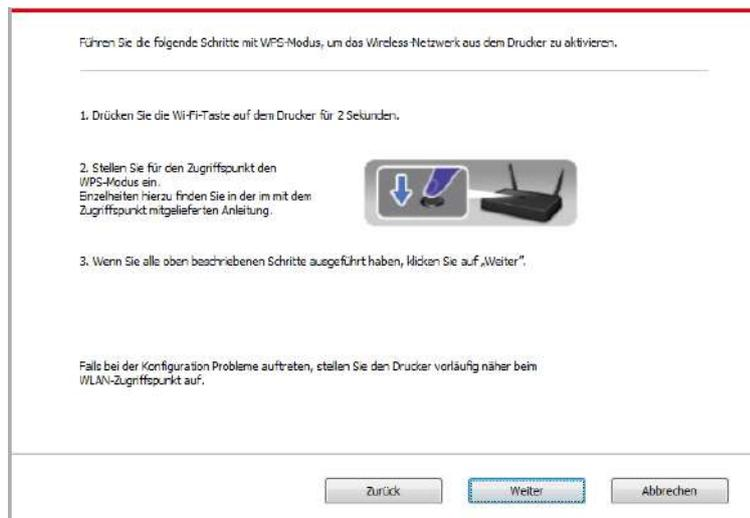
2) Nach dem Wi-Fi-Anzeige wird es ermittelt, ob der Drucker erfolgreich verbunden ist. Wenn die Konfiguration fehlschlägt, klicken Sie auf "Zurück", um die Konfiguration neu zu starten, wenn die Konfiguration erfolgreich ist, klicken Sie auf "Fertig", um die Konfiguration abzuschließen.
