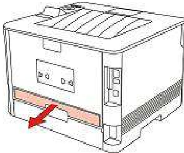
2. Entfernen Sie das gestaute Papier aus der Duplexdruck-Einheit.
