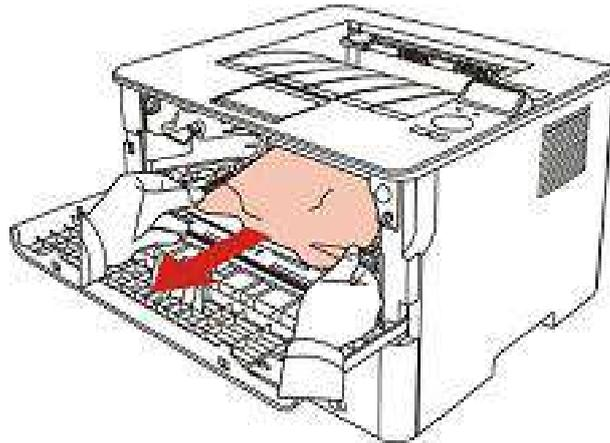
7. Nach dem Entfernen vom Papier legen Sie die Lasertoner bitte wieder in den Drucker. Öffnen und schließen den Frontdeckel, dann kann der Drucker wieder drucken.
