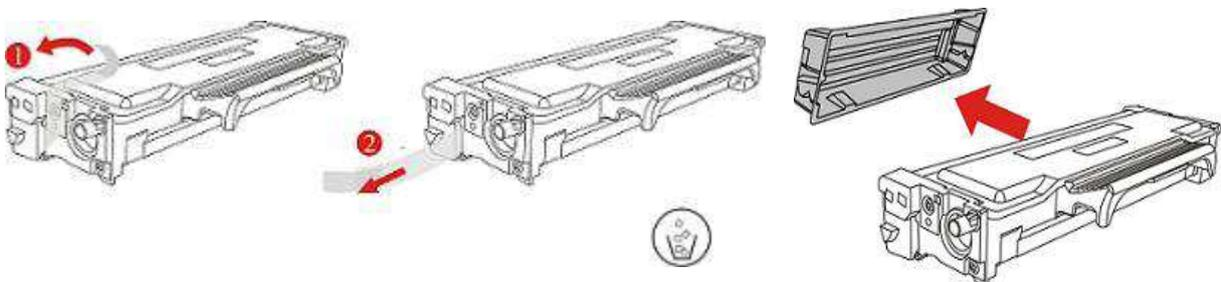
6. Entlang der Schiene des Trommelmoduls legen Sie den Toner im Trommelmodul und erledigen Sie die Installation.
