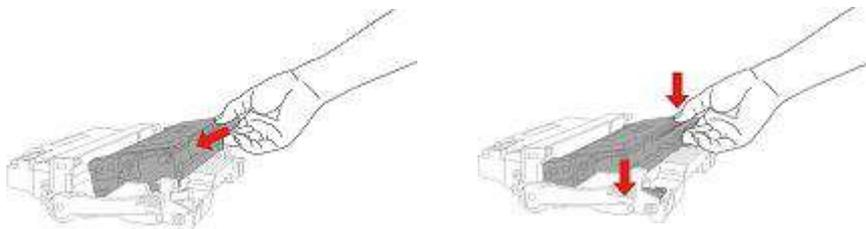
6. Entlang der Schiene des Druckers legen Sie den fertig installierten Trommelmodul im Drucker und erledigen Sie die Installation.
