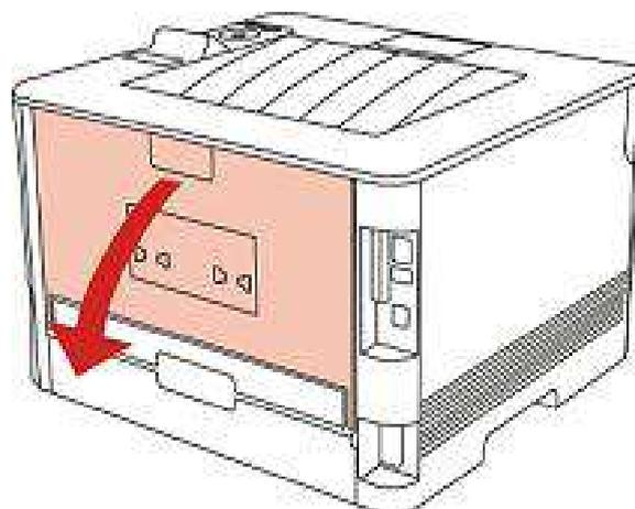
2. Öffnen Sie mithilfe der beiden seitlichen Griffe die Klappe der Fixiereinheit.
