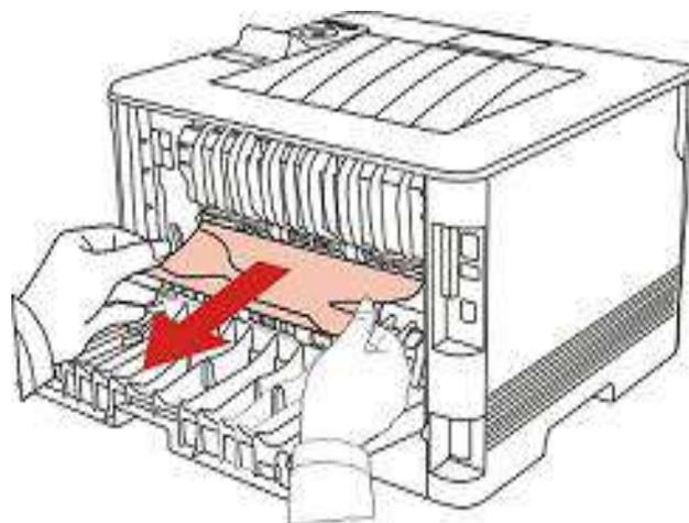
4. Nach dem Entfernen vom Papier schließen Sie den Rückdeckel, öffnen und schließen Sie den Frontdeckel, dann kann der Drucker wieder drucken.
