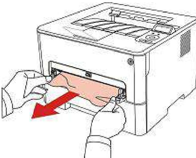
2. Nach dem Entfernen vom Papier legen Sie die Karton bitte wieder in den Drucker. Öffnen und schließen den Frontdeckel, dann kann der Drucker wieder drucken.
